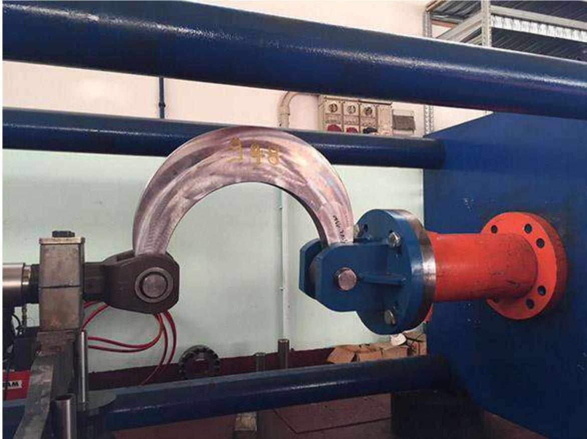
Le connessioni a fusibile che sfruttano l' adattamento plastico dell' acciaio sono realizzate con piastre in acciaio sagomate che con la loro deformazione consentono di dissipare l' energia sismica.
